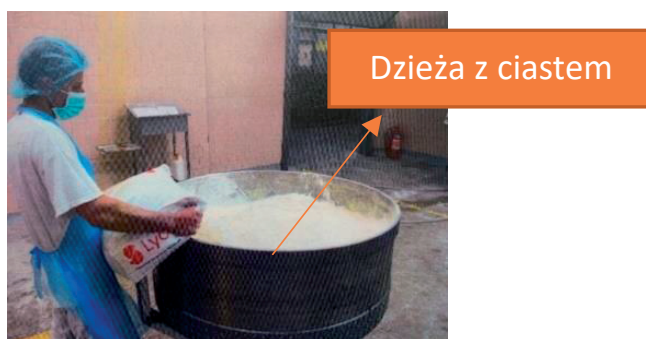
Rys. 4. Ważenie oraz napełnianie dzieży i pojemników surowcami
